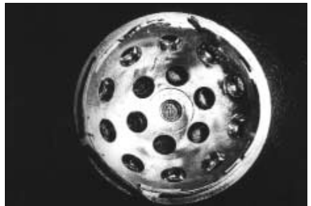
Figura 9. Caso 5. El inserto del cotilo HGII se presentaba suelto por la rotura de dos aletas de fijación.
