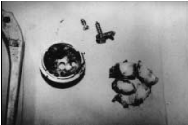
Figura 2. Caso 1. Cinco aletas de fijación rotas determinan la pérdida de fijación del inserto. Este está quebrado en varios fragmentos. La cabeza femoral ha determinado la usura del componente metálico y de las cabezas de los tornillos.
